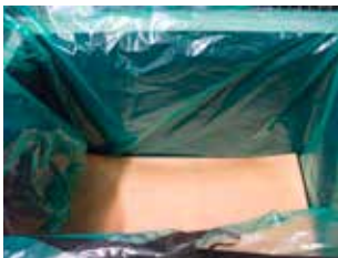
Branorostpapier auf die neue Kunststofflage legen
