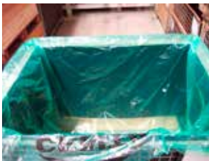
Gitterbox mit Seitenfalthaube ausschlagen
