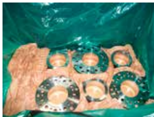
Packpapier Natron Misch 80 g oder Branorostpapier 80 g als Polsterung der Materialien verwenden
