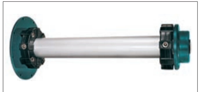
CENTAFLEX-A-G/A-GZ/A-GS dreh- schwingsweiche elastische Gelenkwellen für Winkel bis 2° pro Element T = 0,1 - 14 kNm
